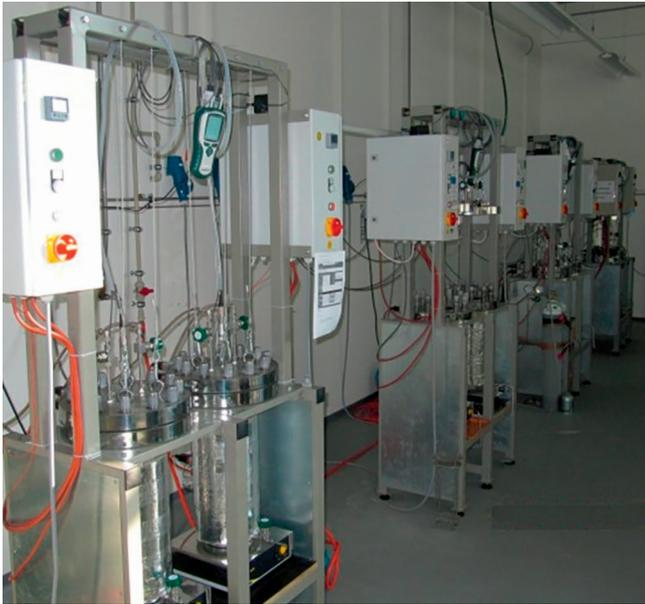
**Bild 1.** Alterungsprüfungen werden mittlerweile auch in Hochdruckautoklaven (links) durchgeführt. Dadurch lässt sich das thermo-oxidative Versagen von Kunststoffbauteilen zeitraffend ermitteln (rechts) (© SKZ)
